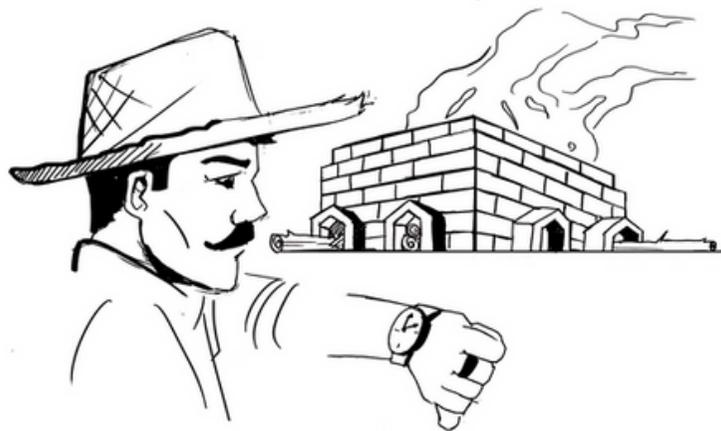
O processo de queima dura em média de 6 horas. O forno do mestre é produzido com os próprios tijolos, possui as dimensões de 4x4 e cabe 8.000 mil tijolos.
