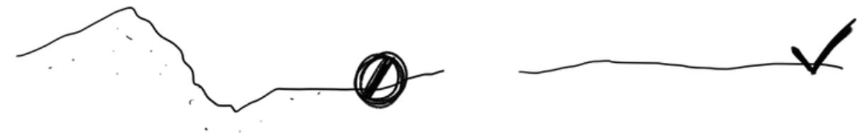
A escolha do terreno onde será posicionado a casa, é a primeira precaução que deve ser adquirida. É indicado que ela seja implantada em um terreno plano, construções feitas de pau a pique quando realizadas em terrenos com declividade ou aclive, correm riscos de serem danificadas com água da chuva e infiltração quando não executada com um excelente alicerce.
