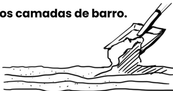
É importante que o barro seja colocado aos poucos e sendo pilado de acordo com a camada. Suponhamos que o baldrame possua 30cm de altura, o mestre indica não preencher de barro até o nível desejado e só no final pilar, porque quando for compactado, o barro não descerá todo, apenas será prensado a parte superior, mas a inferior não. Faça por camadas, até chegar ao nível desejado.
