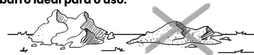
Tenha cuidado ao escolher o barro para a fabricação. É necessário que ele não seja muito arenoso, pois o chão pode não dar certo. Existem barros que após ser pilado, quando secos se desmancham, já outros quando pilado juntamente com o uso recorrente ao longo dos anos, endurece ainda mais. Quanto mais colento e argiloso o barro for, melhor seu desempenho na produção. A região de Mucugê possui excelente material para a execução dessa técnica.
