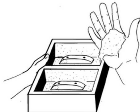
Anteriormente ao processo de moldar o barro nas formas, é de suma importância preparar elas passando areia em seu interior. Esse passo juntamente ao 2, contribuirá que ao desmoldar o tijolo, ele se solte com facilidade.
