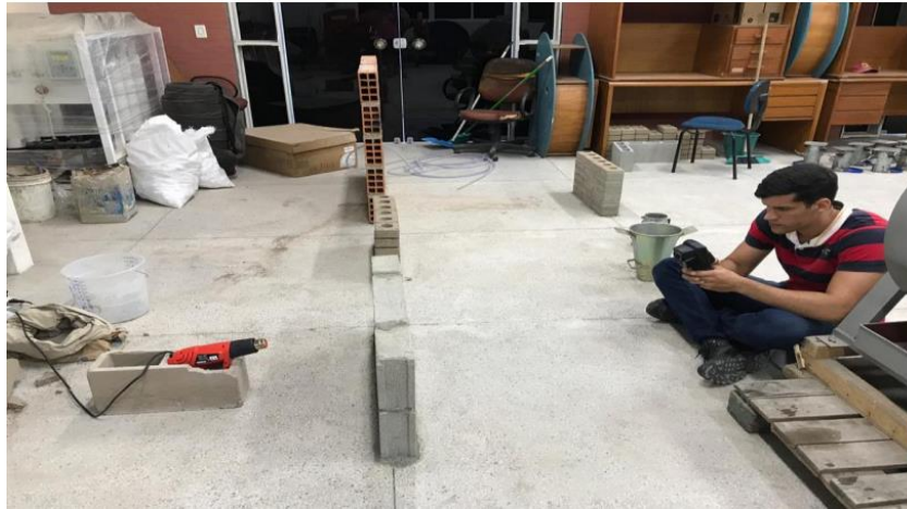
Figura 3.6 - Medição da temperatura na alvenaria de bloco de concreto.
