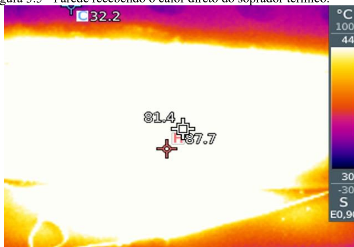
Figura 3.5 - Parede recebendo o calor direto do soprador térmico.
