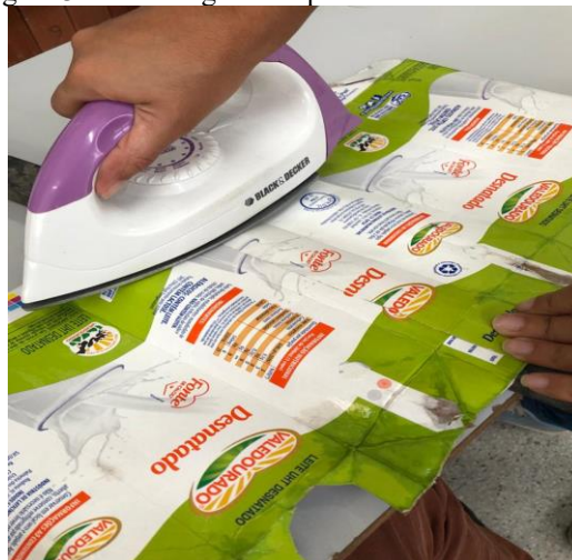
Figura 3.1 - Montagem das placas de caixa Tetra Pak.
