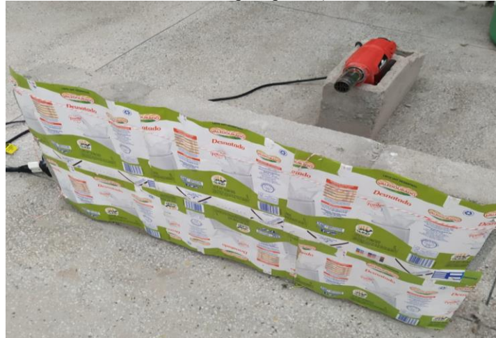
Figura 3.3 - Soprador térmico e alvenaria de blocos de concreto com placa de Tetra Pak (face do alumínio voltado para parede).
