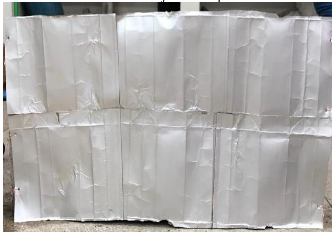
Figura 3.2 - Placa de caixas de leite ajustada na parede de blocos de concreto.
