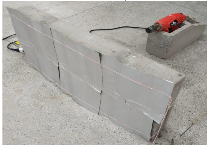
Figura 3.4 - Soprador térmico e alvenaria de blocos de concreto com placas de Tetra Pak (face do alumínio para área externa).
