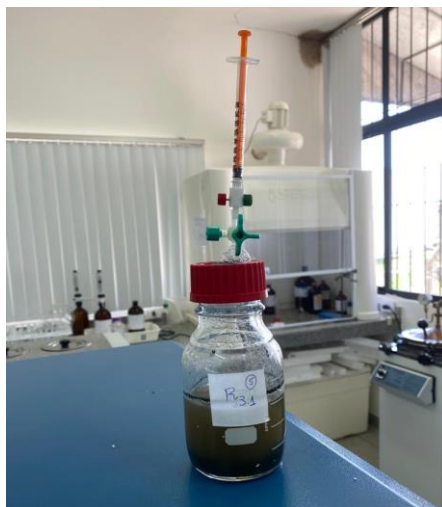
Figura 7: Sistema de válvulas acoplada nos reatores e Seringa utilizadas.
