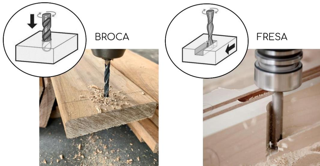
Figura 10 — Diferença entre broca e fresa. Fonte: adaptado de Brasília Fab Lab (2017); Oliveira e Swoboda (2023); Garcia (2022).
