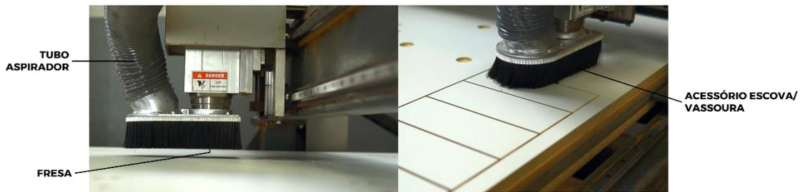
Figura 8 — Aspirador embutido de uma fresadora router CNC. Fonte: adaptado de Rhino Máquinas (2022).
