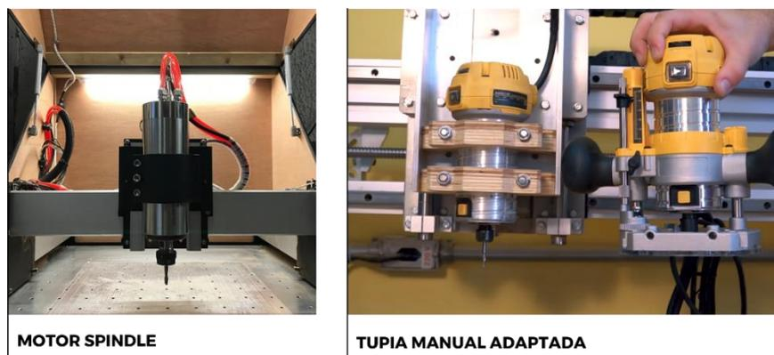
Figura 7 — Diferença entre um motor spindle e tupaia manual adaptada de uma fresadora router CNC. Fonte: adaptado de Bonathan (2017); Thenório (2019).
