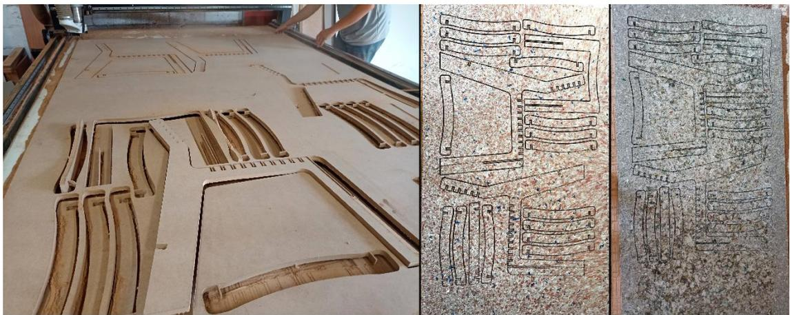
Figura 24 — Chapas com corte finalizado por máquina router CNC. Fonte: da autora (2023).
