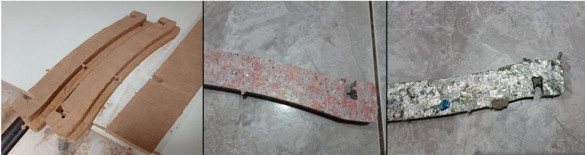
Figura 26 — Marcas das pontes nas peças usinadas. Fonte: da autora (2023).
