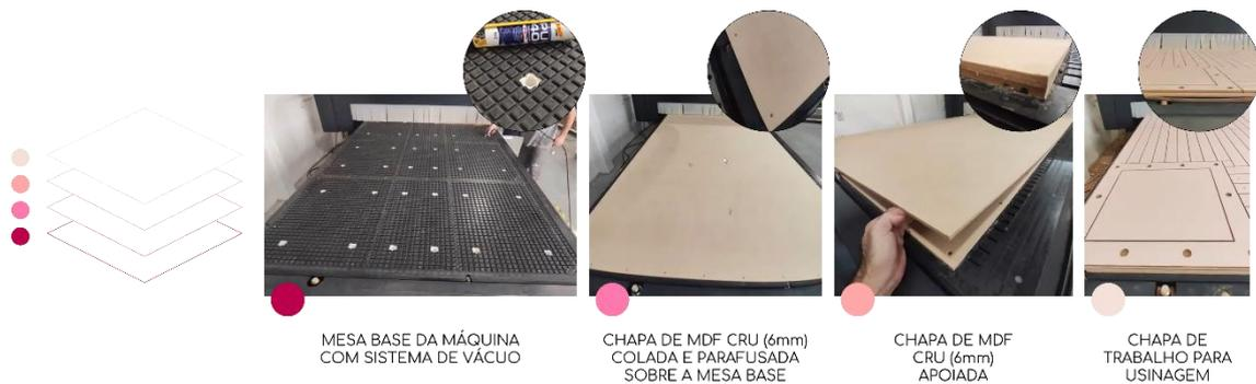
Figura 6 — Camadas da área de trabalho de uma fresadora router CNC. Fonte: adaptado de Medeiros (2023).
