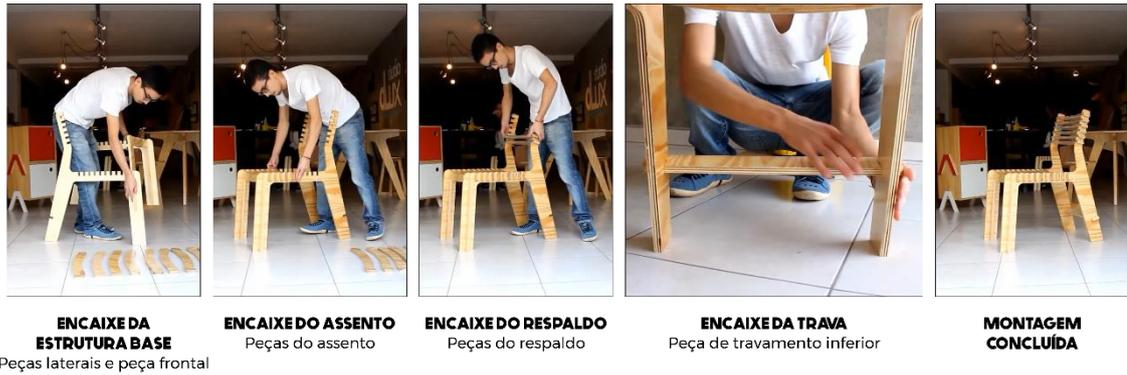
Figura 29 — Sequência de montagem da cadeira Valoví por Denis Fujii. Fonte: adaptado de Studio dLux (2015).
