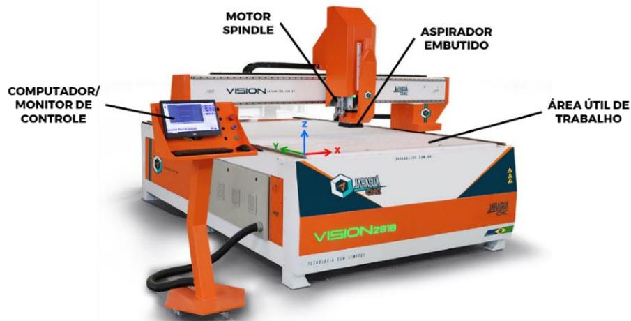
Figura 5 — Elementos básicos de uma fresadora router CNC. Fonte: adaptado de Jaraguá CNC (2023).
