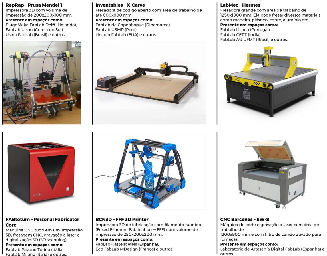
Figura 4 — Máquinas de fabricação digital presentes nas FabLabs pelo mundo. Fonte: adaptado de Fablabs.io (2023a; 2023b; 2023c; 2023d; 2023e; 2023f); LabMec (2023).
