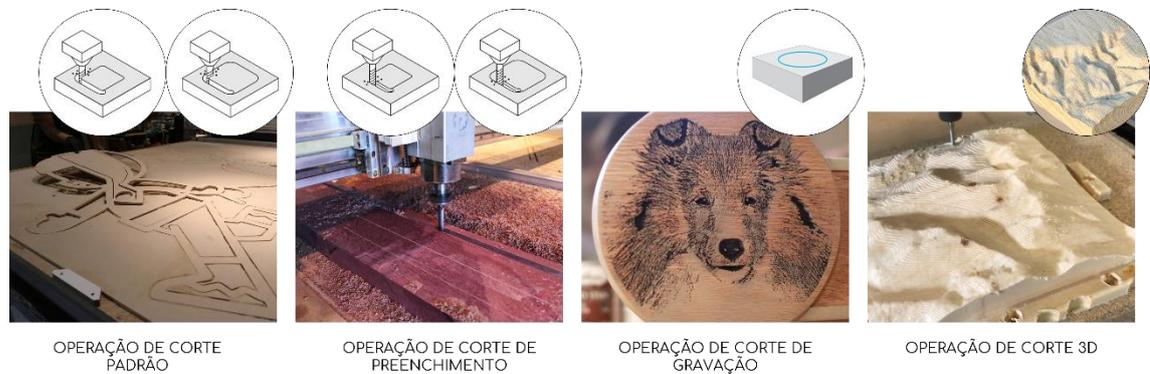
Figura 12 — Tipos de operações de corte. Fonte: adaptado de Tipos... (2021); Oak Lines (2021); Dickinson (2021); Worley (2017); Brasília Fab Lab (2017).
