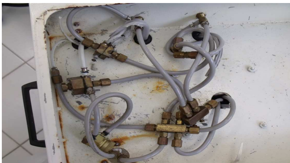
Figura 4- Circuito hídrico do equipo odontológico
