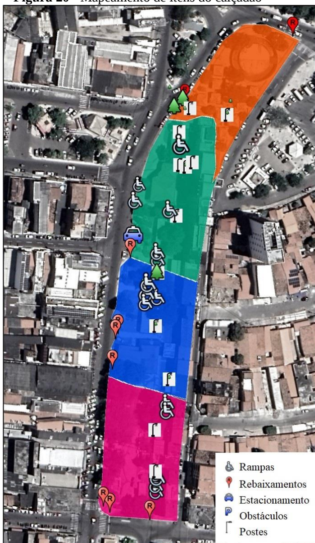
Figura 20 - Mapeamento de itens do calçadão
