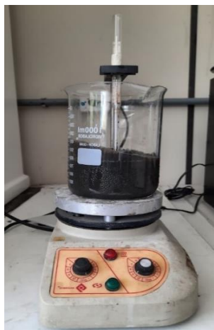
Figura 12: Tratamento Térmico do Lodo de ETE
