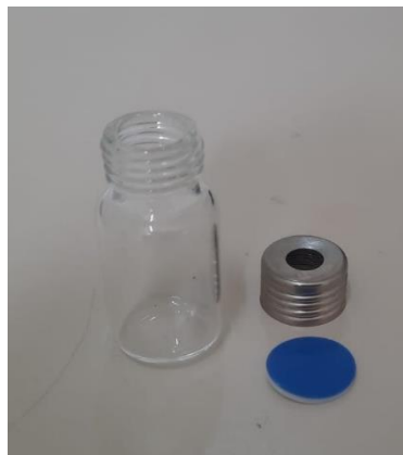
Figura 15: Frasco padrão de vidro com tampa rosqueável e septo de silicone
