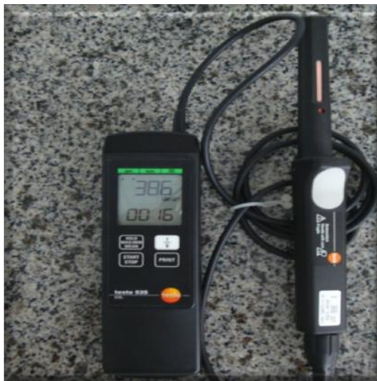
Figura 8: Medidor portátil para avaliação da concentração de CO 2
