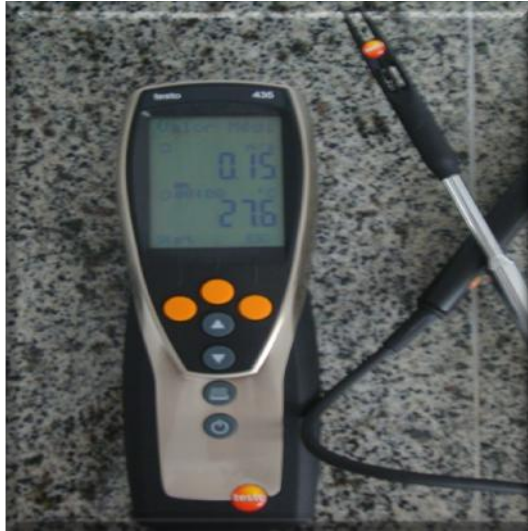
Figura 9: Termo-higrômetro digital para avaliação de temperatura, umidade relativa e velocidade do ar
