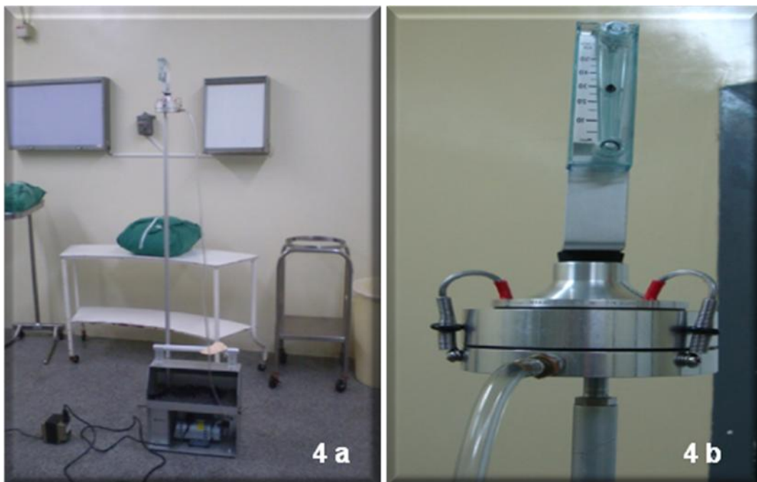
Figuras 4a e 4b: Amostrador de Ar do tipo Anderson ® de um estágio utilizado para a coleta de bioaerossóis
