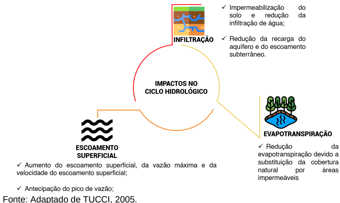
Figura 1 – Impactos gerados no ciclo hidrológico em função das consequências do processo de aumento da malha urbana.
