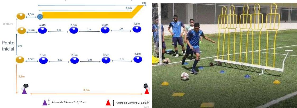
Figura 4 – Vista aérea (esq.) da disposição do espaço demarcado para filmagem da execução do protocolo de chutes e posterior rastreamento usando o software Dvideow. A bola foi posicionada na marca de 1,5 metros de distância do ponto inicial. A direita, é possível visualizar a execução do chute no espaço calibrado.
