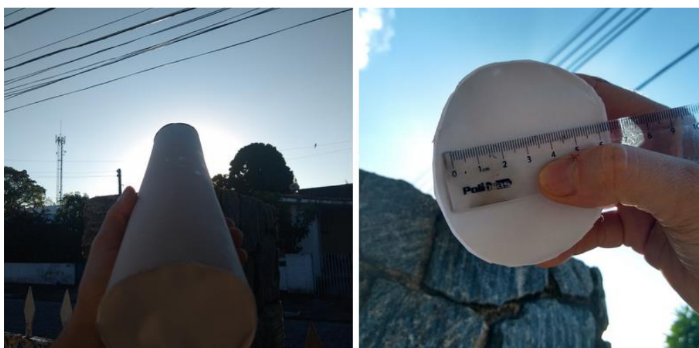
Figura 4.10. Câmara escura de orifício sendo utilizada para medir o diâmetro do Sol, note que o observador está abrigado da radiação direta solar.
