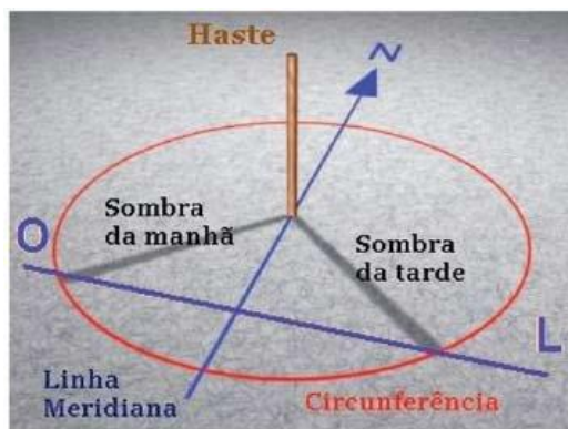
Figura 9: Marcação dos dois pontos sobre uma mesma circunferência. A reta que passa pelos pontos é a direção Leste-Oeste e a bissetriz do ângulo formado pelos dois pontos e centro da circunferência será a linha meridiana, a direção Norte-Sul.
