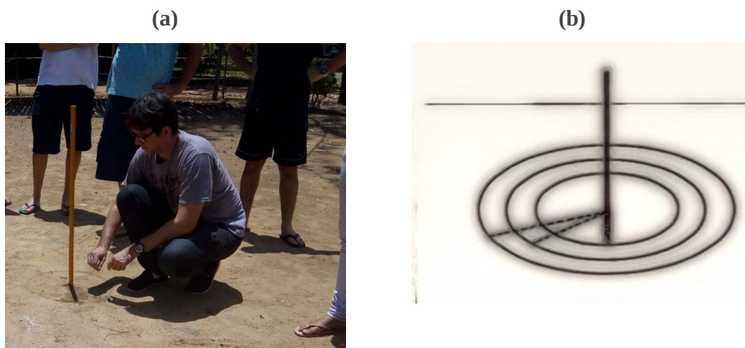
Figura 7: (a) Foto mostrando uma pessoa traçando um círculo sobre a extremidade da sombra. (b) Figura mostrando vários círculos obtidos após várias marcações da posição da sombra.
