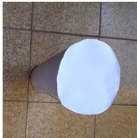
Figura 5: Com o papel vegetal (ou chamex) será construída a tampa (fundo do tubo) que será a tela de projeção da imagem do disco solar.
