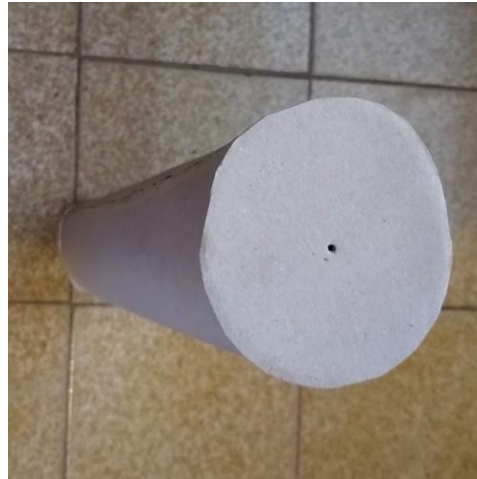
Figura 4: Tampa de umas das bases do cilindro. Neste caso essa será a face (frente do tubo) que deverá ser apontada para o Sol.
