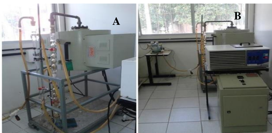
Figura 3. Forno utilizado para produção de biochar. (A) Sistema de condensação; (B) aparato experimental para realização da pirólise. Fonte: autor
