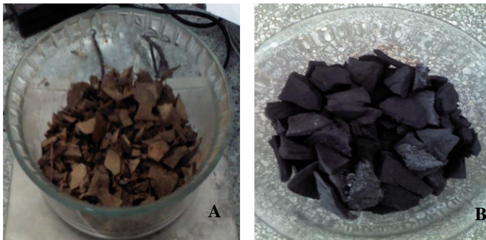
Figura 2. Biochar antes (A) e após o processo de trituração (B) para obtenção da granulometria igual ou inferior a 0,42 mm. Fonte: autor.
