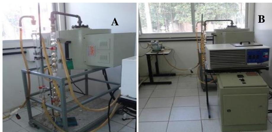
Figura 3. Forno utilizado para produção de biochar. (A) Sistema de condensação; (B) aparato experimental para realização da pirólise. Fonte: Tenório (2017)
