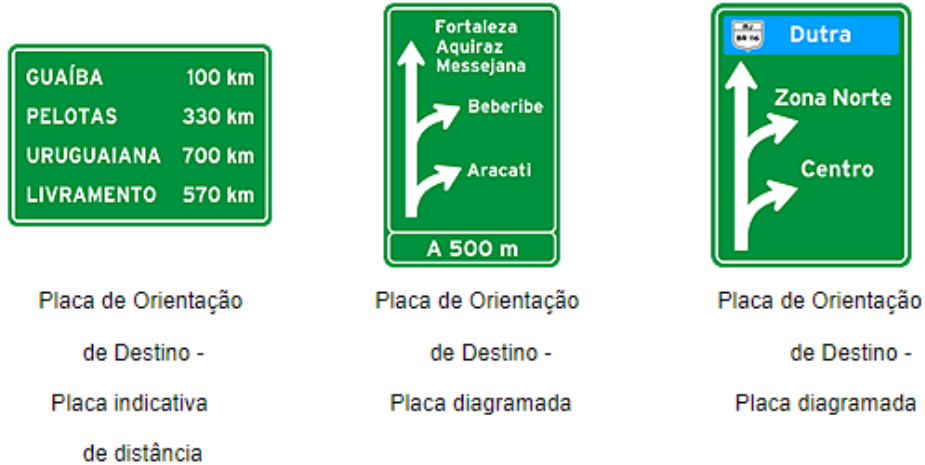
Figura 25: Sinalização de indicação
