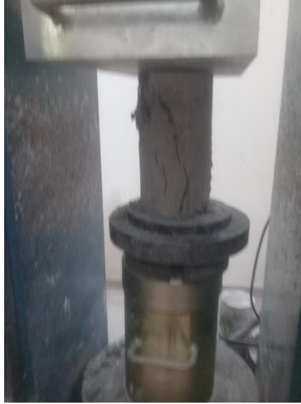
Figura 27 – Corpo de prova após o seu rompimento
