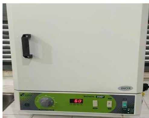
**Figura 13** – Estufa utilizada para secagem das amostras por 24h.
