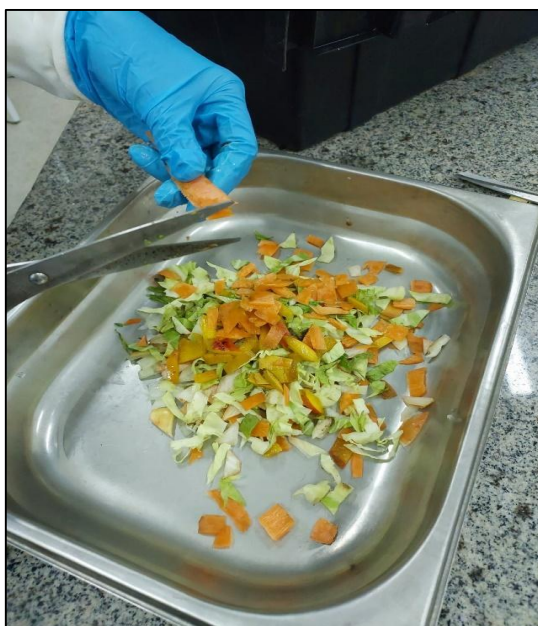
Figura 9: Trituração manual dos resíduos de alimentos
