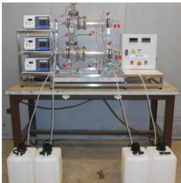
Figura 5 - Decantadores com misturadores ( Mixer settler ) para ExLL.
