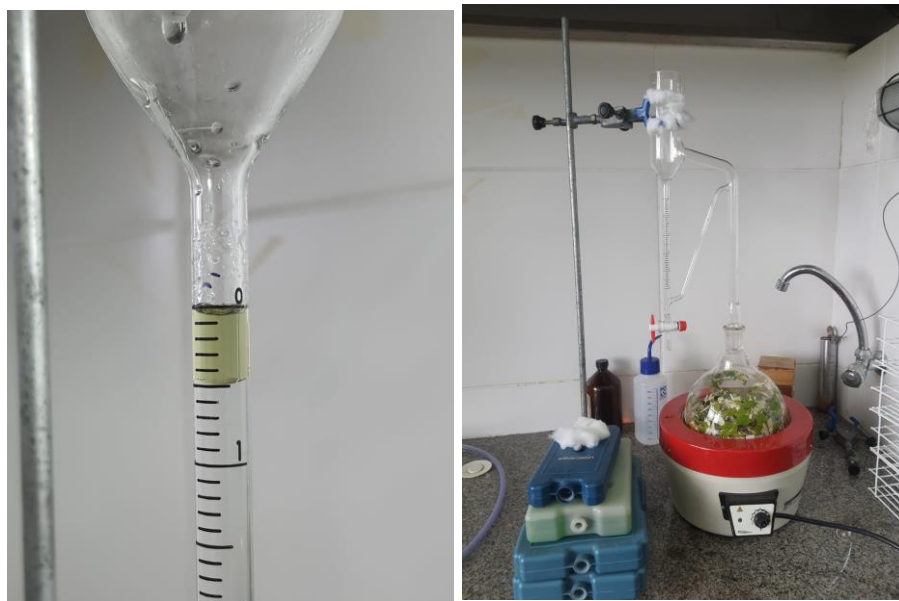
Figura 6 – Extração dos óleos essenciais por hidrodestilação
