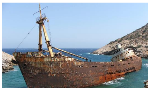
Figura 6: Navio em processo de corrosão Fonte: http://nomadesdigitais.com/wp-content/uploads/2014/04/navio-topo.jpg
