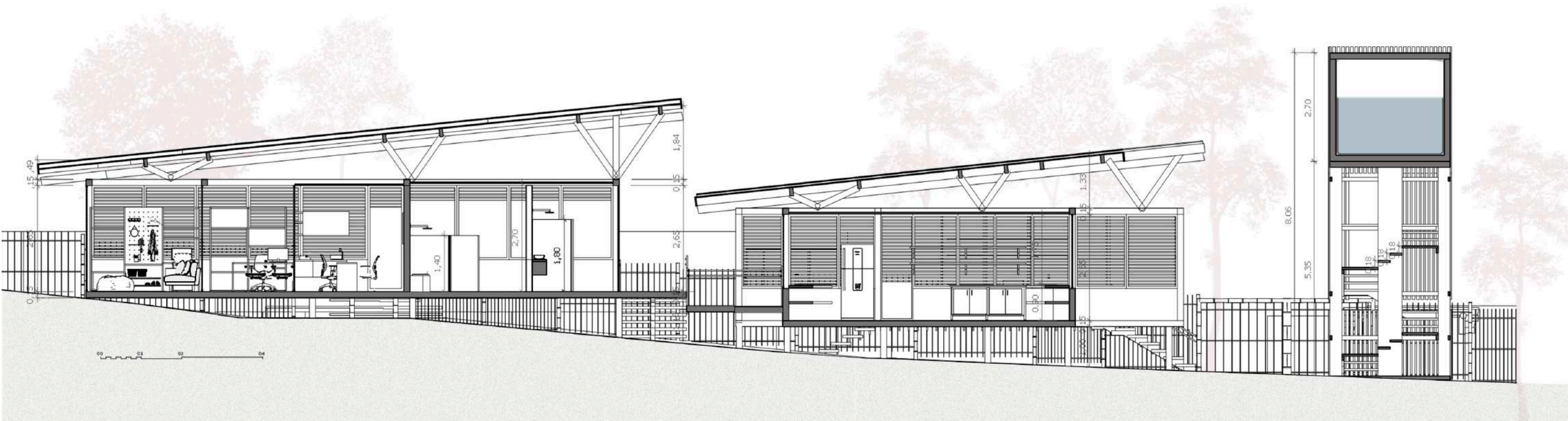
Corte Longitudinal - Bloco Adm e Cozinha
