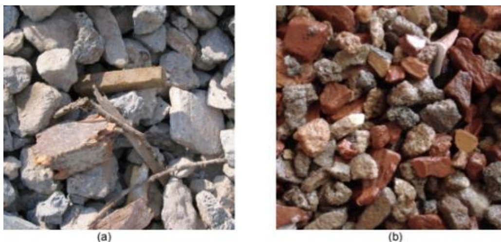
Figura 5: Agregado de concreto reciclado (a) e agregado de RCD misto (com cerâmica vermelha) (b).
