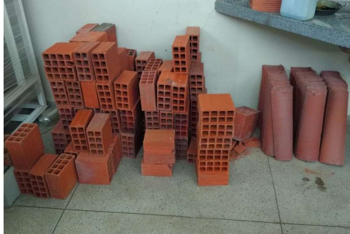
Figura 4 – Depósito de blocos e tijolos cerâmicos
