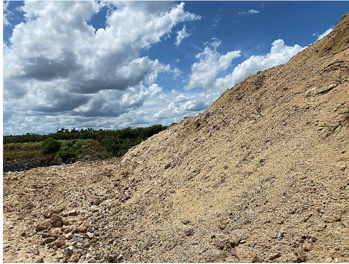
Figura 28. Pilha de estéril do processo de decapeamento.
