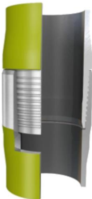
Figura 5.22 – Conexão entre elementos tubulares.
