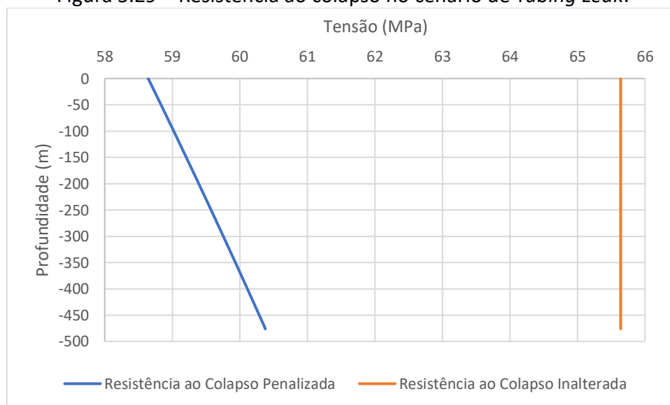
Figura 5.29 – Resistência ao colapso no cenário de Tubing Leak .
