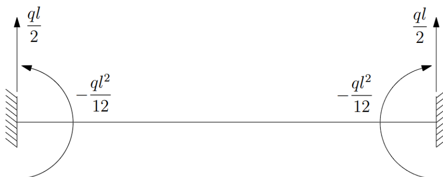
Figura 14 – Forças nodais equivalentes.
