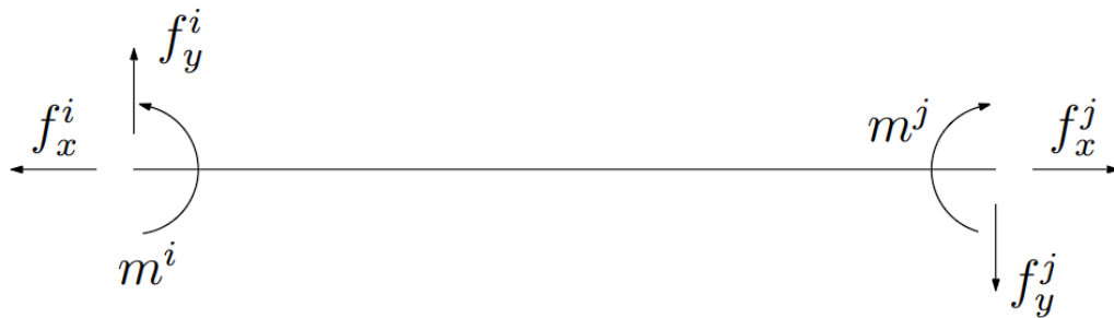
Figura 9 – Forças representadas no vetor de forças [F] .
