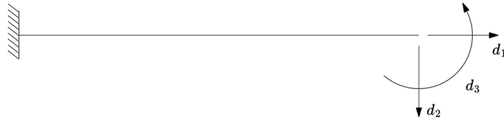
Figura 10 – Graus de liberdade em uma barra engastada.
