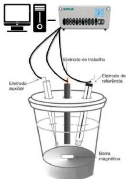
Figura 11. Cella Eletroquímica contendo os eletrodos (trabalho, auxiliar e referência)
