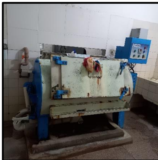
Figura 9 - Máquina de lavar roupa do hospital (Entrada por onde é colocado a roupa suja)
