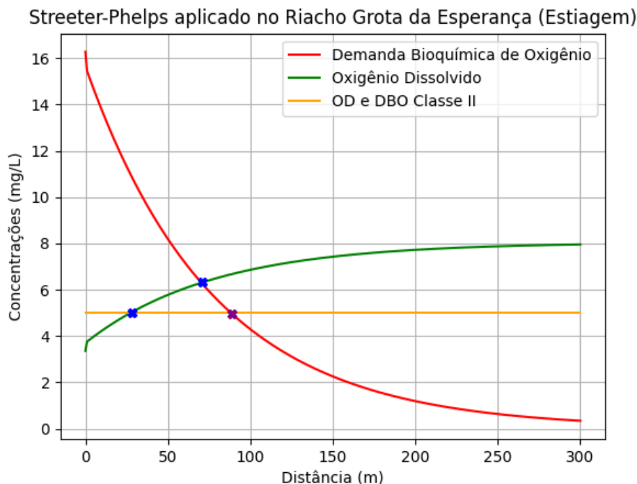
Figura 30: Modelo de Streeter-Phelps em função do período de estiagem
