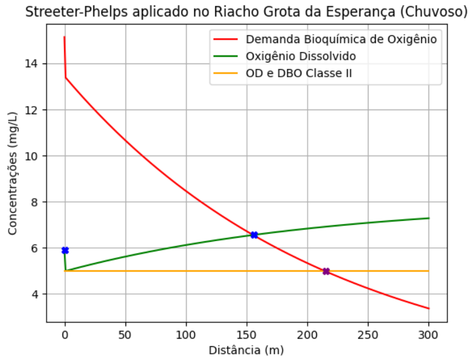
Figura 31: Modelo de Streeter-Phelps em função do período chuvoso
