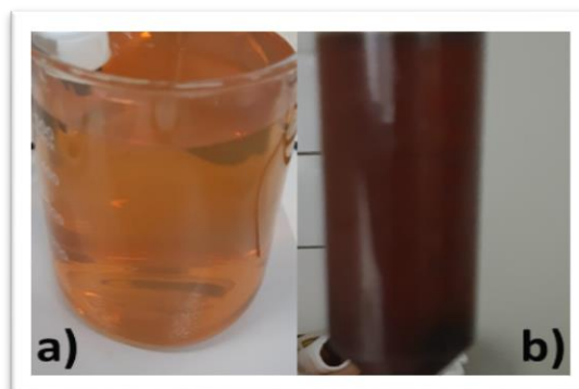
Figura 19. Aspecto da coloração da síntese verde de nanopartículas de prata, em a) síntese sendo preparada com o EPV com aspecto de vermelho claro, b) aspecto da síntese após
