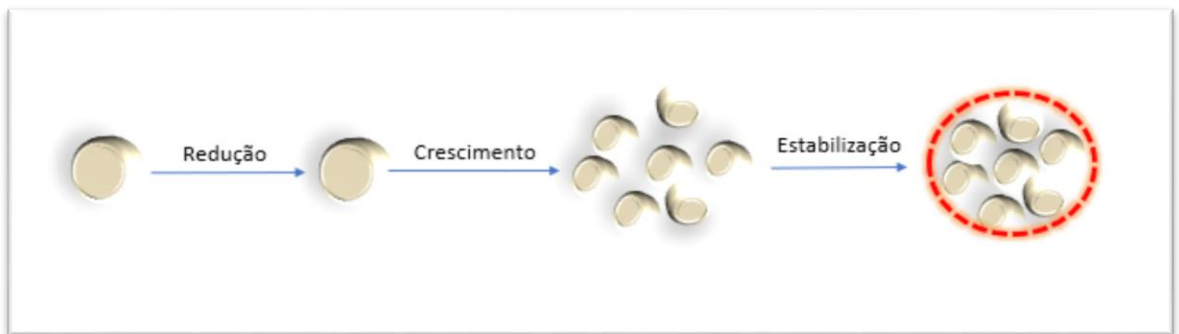
Figura 7. Desenho esquemático do método de síntese biogênica utilizando extrato de própolis vermelha de Alagoas. Fonte: O autor (2021).
