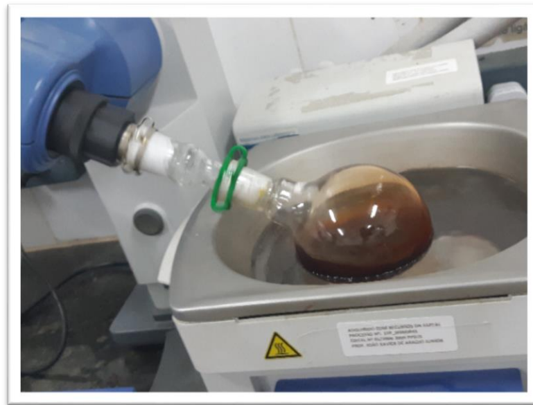
Figura 9. Evaporador rotativo com o extrato etanólico de própolis vermelha de Alagoas, para liberação do solvente residual. Fonte: O Autor (2021).
