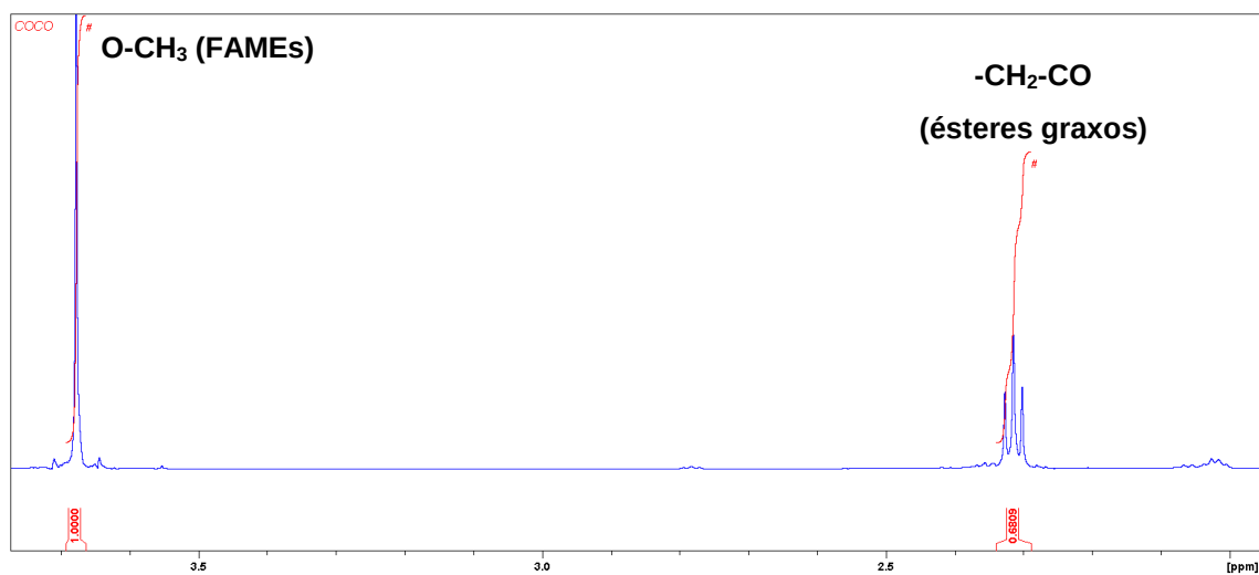
Figura 6: Espectro de em RMN 1H e integração das áreas dos sinais utilizados para determinar a porcentagem de conversão do óleo de coco em FAMES.
