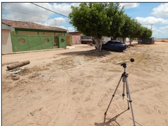
**Figura 35: Medição de ruído sendo realizado próximo ponto de transporte, à margens da rodovia, distrito de Luziápolis, município de Campo Alegre, Alagoas.**
