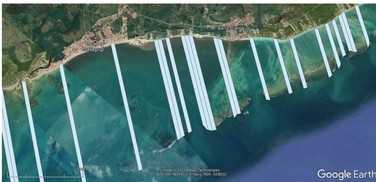
**Figura 4.** Transectos perpendiculares à linha de costa de Maragogi utilizados nos sobrevoos com o Drone.
