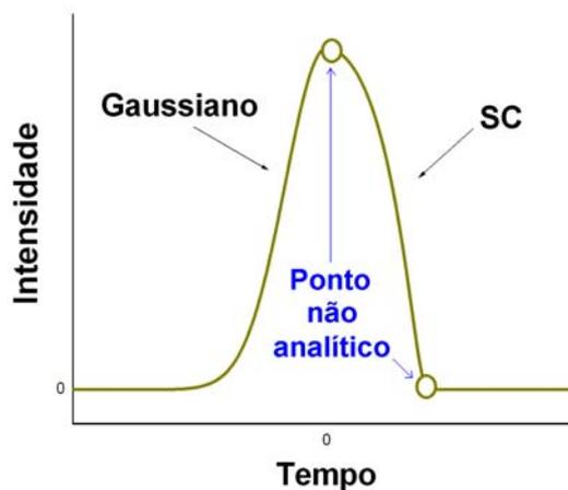
Figura 3.19: Esquema de um pulso que apresenta uma distribuição tipo gaussiana com suporte compacto (pulso GSC).
