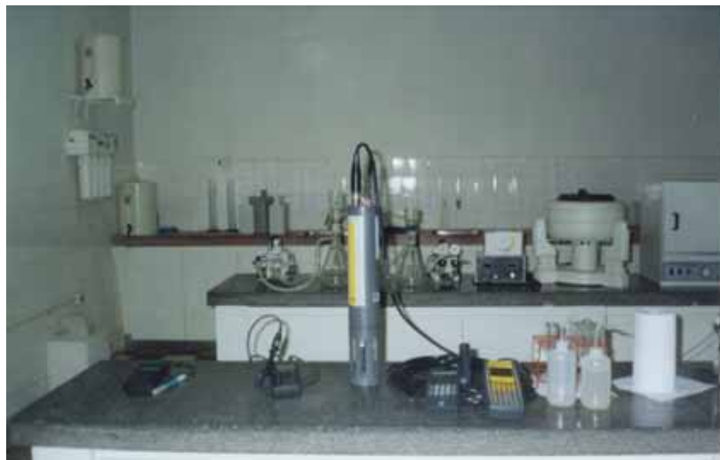
Figura 9: Sonda multiparamétrica YSI modelo 6600, usada para análise da clorofila “a”.
