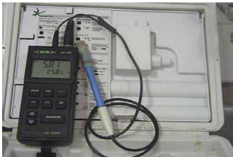
Figura 10: pHmetro, usado para medidas de pH, suas medidas vão de 1 a 14.
