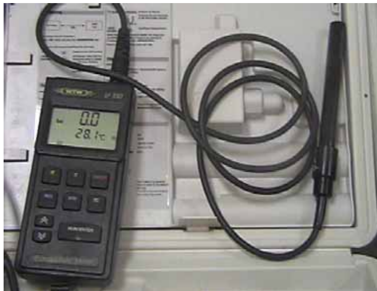
Figura 7: Condutivímetro ou salinômetro, modelo LF 330 da marca WTW. Para determinação da condutividade e salinidade.
