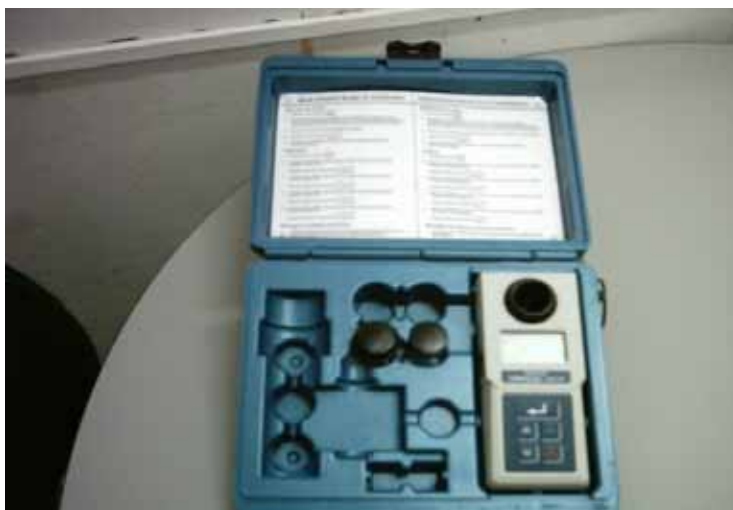
Figura 8: Turbidímetro de análise direta, Turbquanta fabricado pela MERCK.
