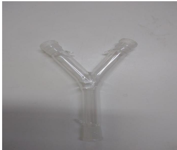
Figura 10 Olfatômetro em “Y” utilizado nos bioensaios
