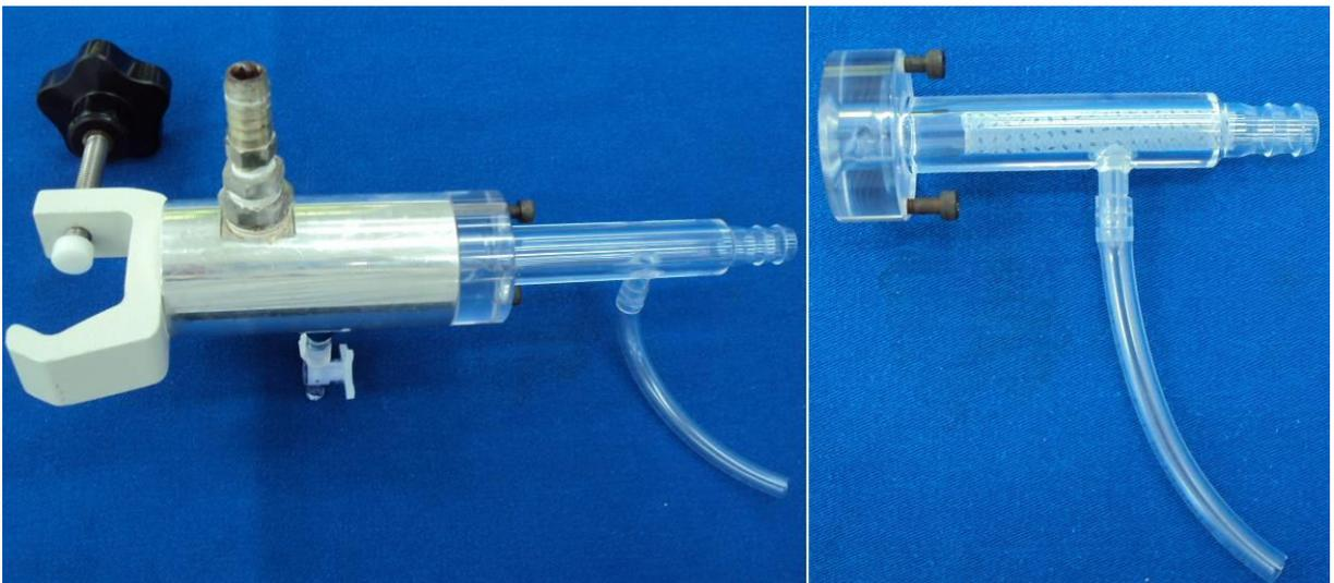
**Figura 11.** Aparato utilizado para realização dos testes de permeabilidade dos stents.
