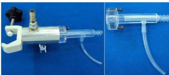
**Figura 4. Aparato utilizado para realização dos testes de permeabilidade dos stents**
