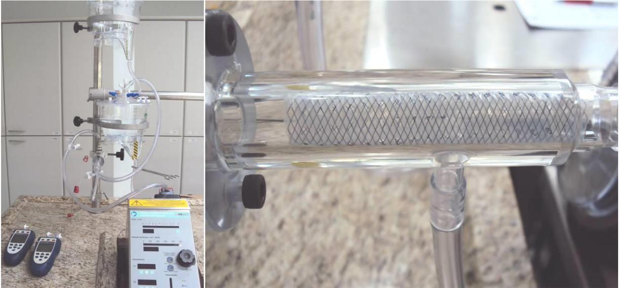
**Figura 10.** Ilustração do aparato utilizado para realização dos testes e detalhe do “vaso periférico” onde foram coletados os volumes de líquido através das amostras.
