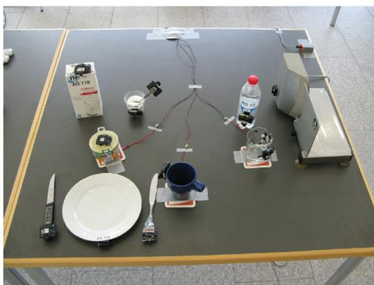
Figura 2.2: Rede de sensores utilizada em Chetty & White (2016), acelerômetros nos objetos utilizados.
