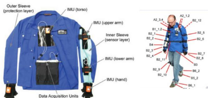
Figura 2.1: Rede de sensores utilizada em Chetty & White (2016), com acelerômetros espalhados pela jaqueta, calça e sapatos.
