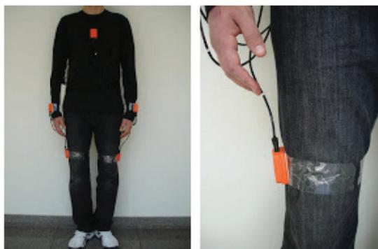
Figura 2.3: Rede de sensores utilizada em Barshan & Yükses (2014), total de 5 sensores acelerômetro/giroscópio.
