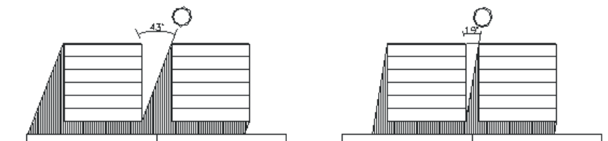
Figura 44 - Esquema da influência do avanço compensatório na insolação nas unidades habitacionais.
