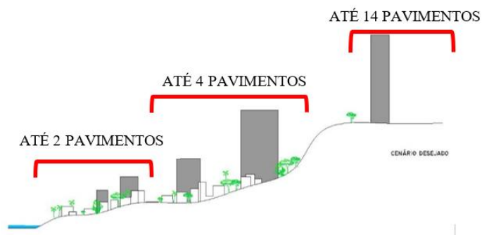
Figura 45 - Proposta de escalonamento dos edifícios para o litoral norte de Maceió.
