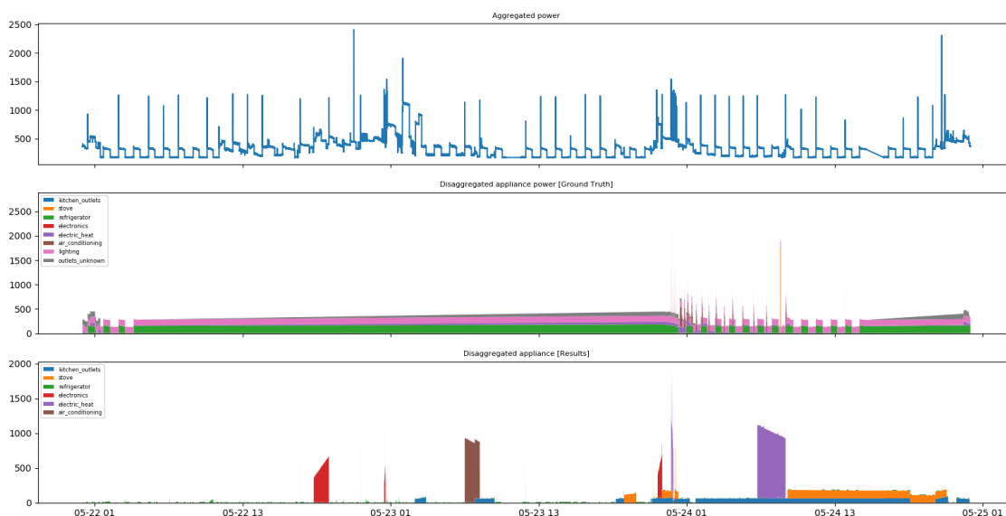
Figura 4.13: Comparação da desagregação feita com os dados da segunda main da casa 6 do REDD com os dados desagregados da mesma casa após a mudança nos parâmetros.
