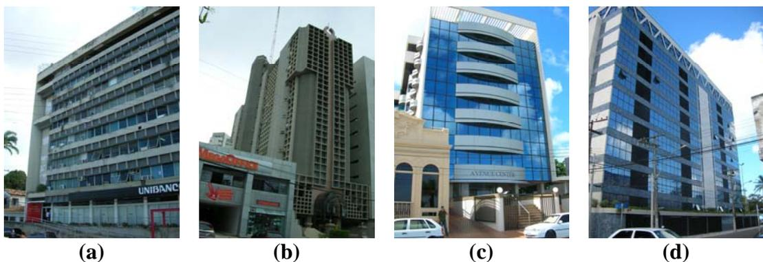
**Foto 2 - Ed. Emp. Ruy Palmeira (a) e Ed. Work Center (b) utilizam dispositivos de proteção solar das fachadas. Ed. Avenue Center no Jaraguá (a) e Ed. Ocean Tower na Pajuçara (b): adotam a “pele de vidro” na suas fachadas.**
