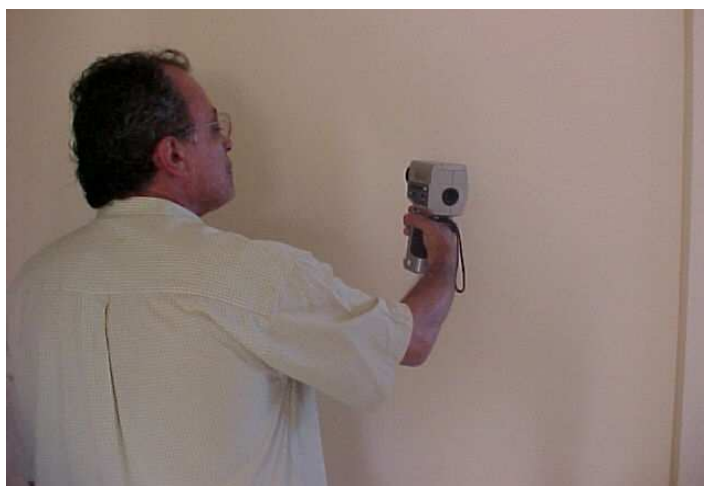
Figura 3.5 - Levantamento dos fatores físicos – Medição da luminância da superfície
