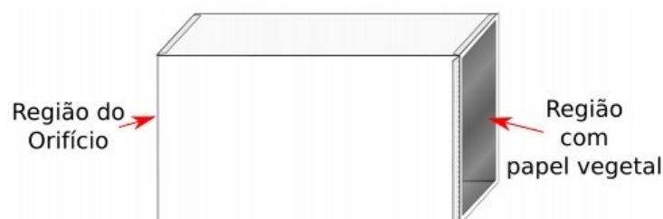
Figura 96 – Câmara escura finalizada.
