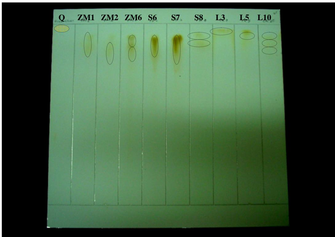
**FIGURA 24.** Perfil cromatográfico (CCD) de flavonóides de Extratos Hidroetanólicos de Pólen (EEP). Placa revelada com cloreto de alumínio ( $\text{AlCl}_3$ ).
