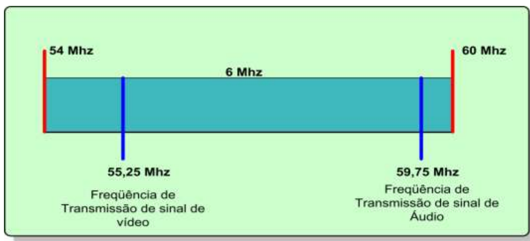
Figura 6 – Espectro do canal 2 com as freqüências de transmissão analógica de Vídeo e Áudio.
