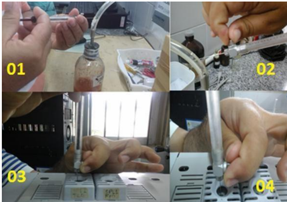
Figura 7 - Coleta (01), Travamento (02), destravamento (03) e Aplicação (04) do biogás.
