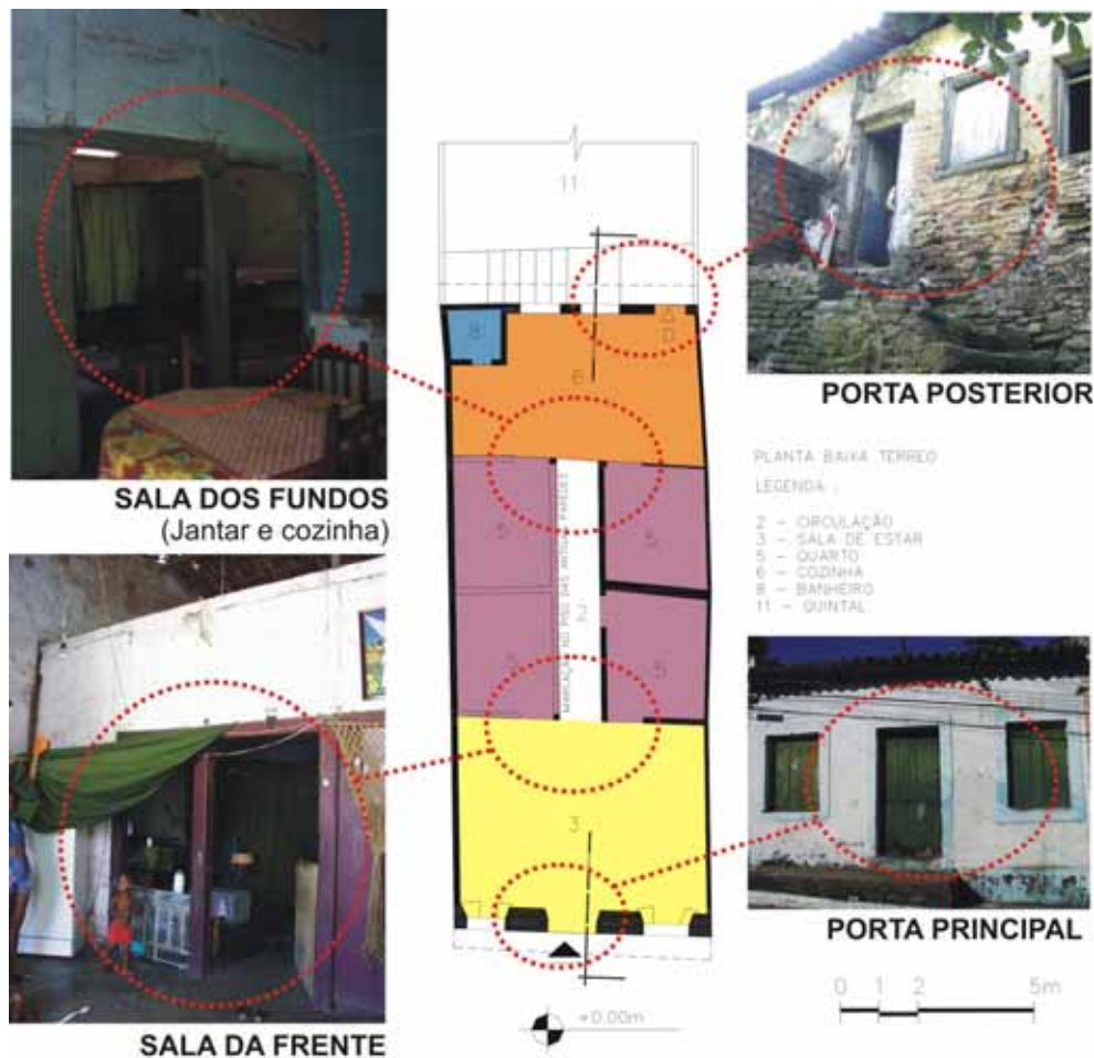
Figura 110 – Planta da casa n° 358 da Rua de São João com a indicação dos acessos.
