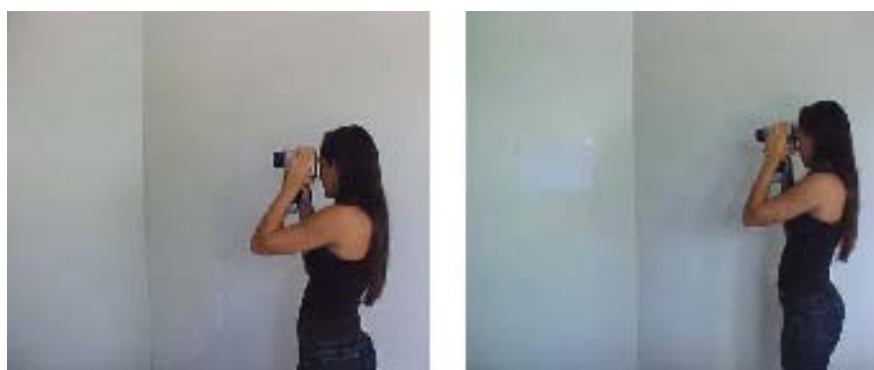
(a) (b) Figura 91: Medição da luminância na parede (a) e no papel branco (b).
