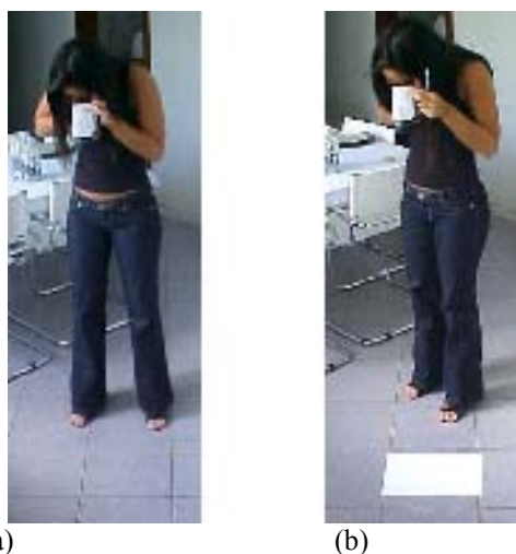
Figura 89: Medição da luminância no piso (a) e no papel branco (b).
