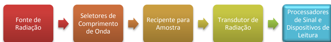
Figura 11 – Esquema dos principais dispositivos em um espectrofotômetro
