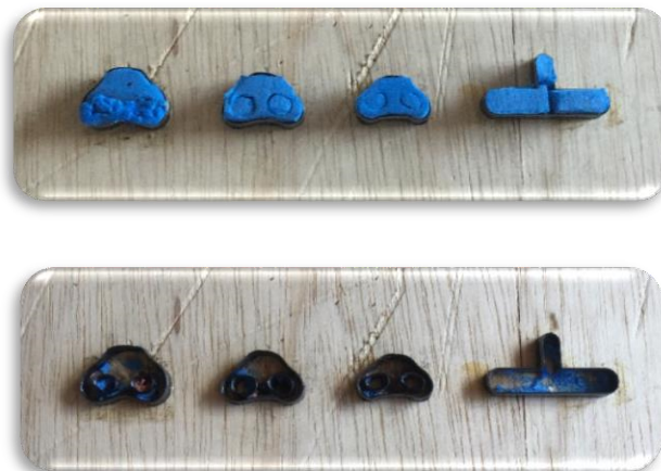
Figura 12 - Faca confeccionada de corte e vinco com os moldes para os protetores nasais.
