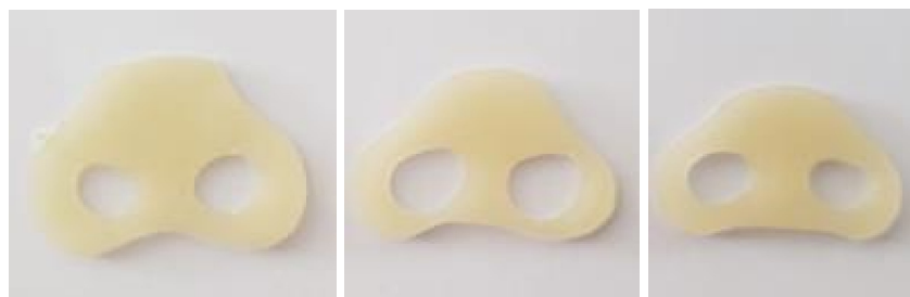
Figura 42 - Protetores nasais reprocessados em método por radiação gama.
