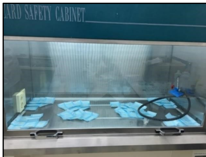
Figura 15 - Disposição dos protetores embalados na capela de fluxo laminar com UV.
