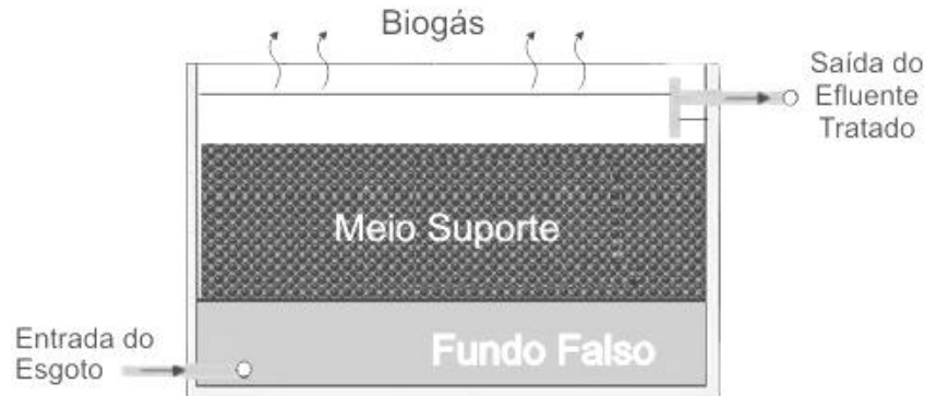
Figura 08 - Reator retangular anaeróbio de leito fixo com fluxo ascendente.
